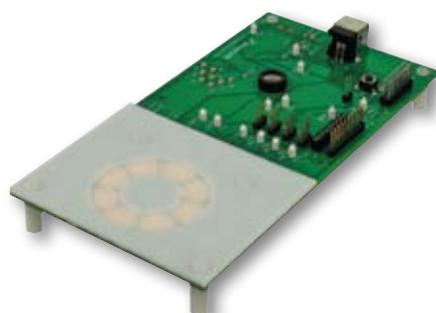
Рис. 6. Оценочная плата для проектирования сенсорного поворотного слайдера с использованием датчика MPR083
