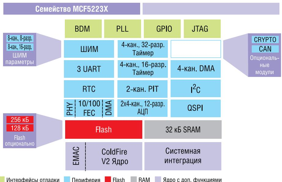
Рис. 2. Структура микроконтроллеров семейства MCF5223X
