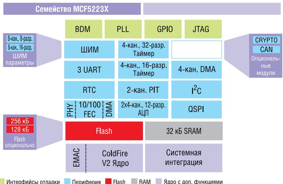
Рис. 2. Структура микроконтроллеров семейства MCF5223X
