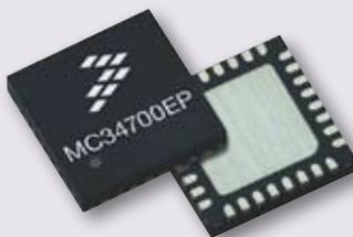
Компания **Freescale Semiconductor** расширила линейку своих приборов для **управления питанием** выпуском **MC34700** – 4-канальной микросхемы, оптимизированной для применения в компактных системах с высоким питающим напряжением. **MC34700** способна работать с широким входным диапазоном напряжений питания от 9 до 18 В, а рабочая частота прибора составляет 800 кГц. Микросхема пред-
